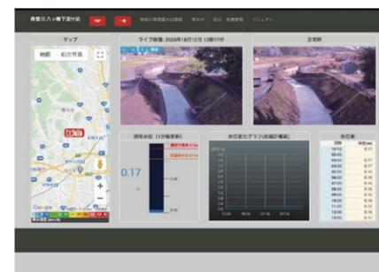
現場の水位監視とあわせて一般に水位の情報を公開。気象庁提供の高解像度降水ナウキャストと連携して降水予測をもとに、安全な排水制御を行えます。
