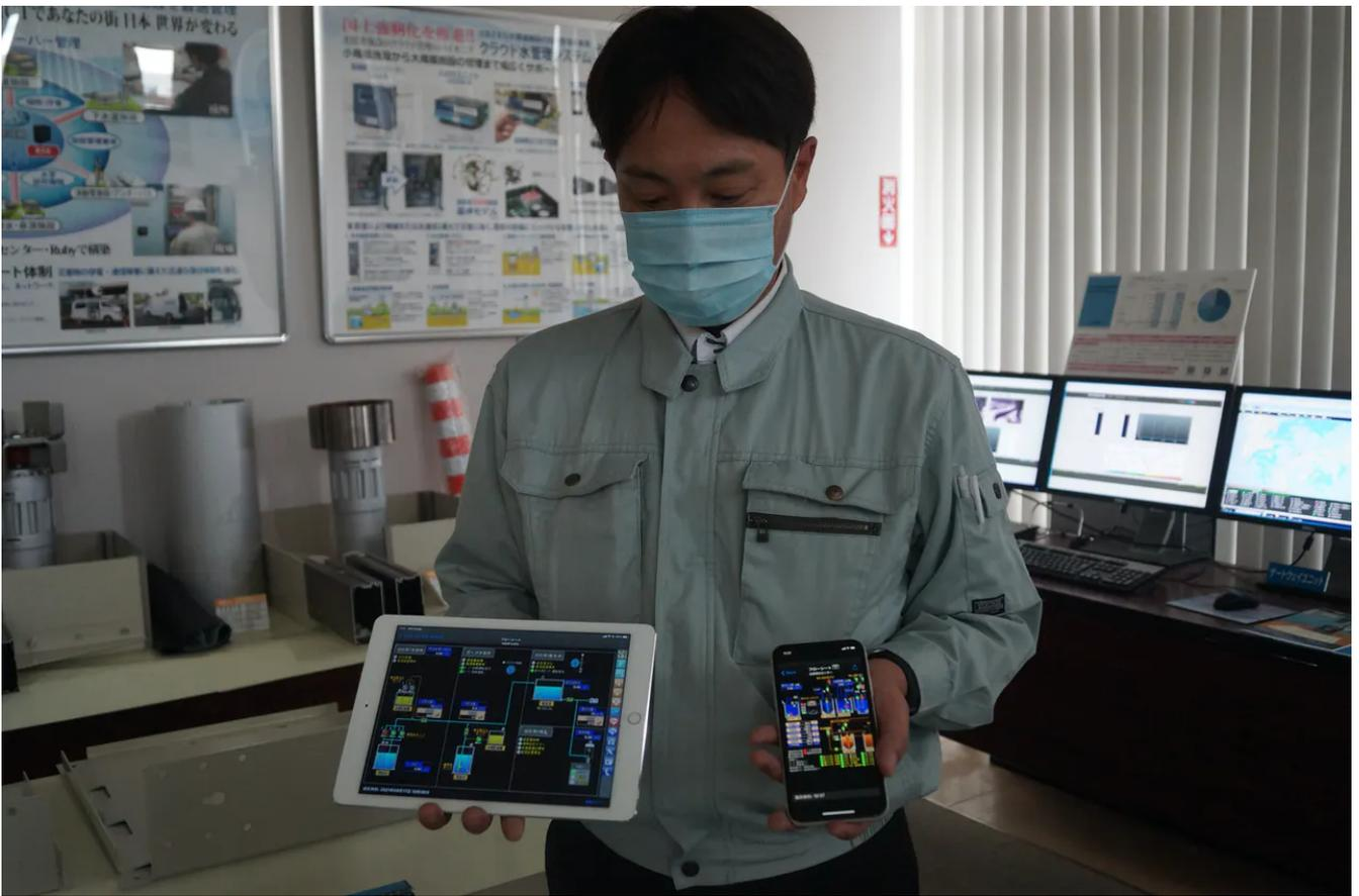
携帯端末やタブレット、パソコンで上下水道の水質や水量などの監視ができる
