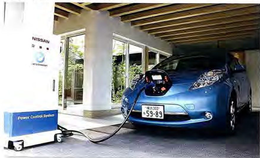
写真1 ●日産自動車の「リーフ」を家庭用蓄電池として活用するシステム 電気自動車リーフに搭載しているリチウムイオンバッテリーから、住宅に給電することで、電力使用のピークシフトなどを実現する
