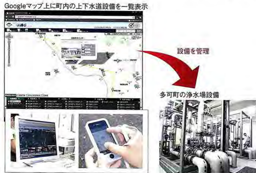
図5◎「Google マップ」とスマートフォンなどを使い上下水道設備を管理する兵庫県多可町
