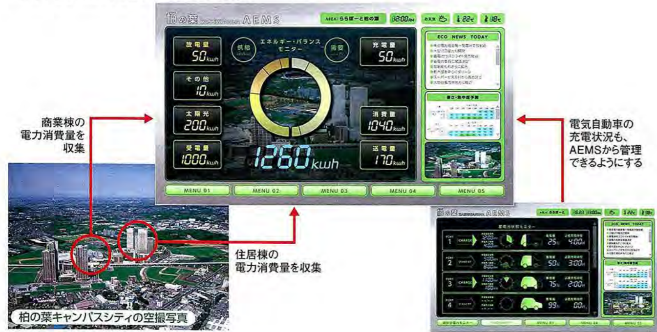
図2●柏の葉キャンパスシティが構築する「AEMS(エリアエネルギー管理システム)」の仕組み 柏の葉で構築するAEMSのイメージ。住居棟や商業棟ごとのエネルギー需給を見える化する。将来は電気自動車の充電状況やヘルスケア情報なども、AEMSを通じて一元管理する計画だ
