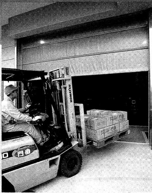
超音波感知でシャッターが高速開閉。新工場での増
