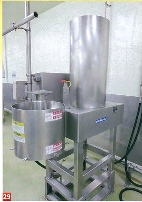
26 冷凍スイートコーンをコンベヤで原料処理室へ搬送 27 原料処理室では最初に目視選別を行い、変色しているものなどを取り除く 28 解凍したコーンをすりつぶす摩砕機 29 コーンなどの食品原料を微粒子サイズに細かくすることが可能なプロセッサ
