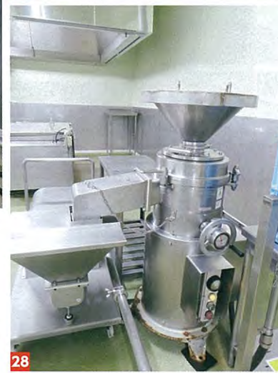
26 冷凍スイートコーンをコンベヤで原料処理室へ搬送 27 原料処理室では最初に目視選別を行い、変色しているものなどを取り除く 28 解凍したコーンをすりつぶす摩砕機 29 コーンなどの食品原料を微粒子サイズに細かくすることが可能なプロセッサ
