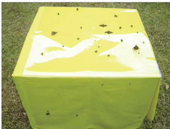
写真3 フィールド試験の様子②黄色に最も虫が集まった（写真提供：大成イーアンドエル）
