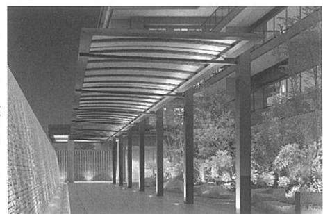
ンシェルター「AR-F型」(建築基準法対応商品): 設計者が求める拡張性を満たした通路用シェルター。建物や街並との調和をめざし、細部のディテールにこだわった直線的でシャープなデザインが特長。本体アルミ形材、屋根材ポリカーボネート(すりガラス調)・アルミ樹脂複合板(シルバー)。灯具と桁が一体化したLED照明(直接・間接照明)を用意。
