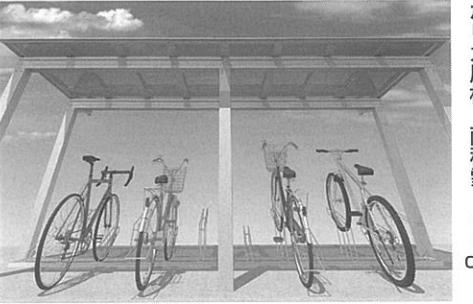
支持上吊りタイプ。耐積雪 20～30cm 相当・耐風圧強度  $V_o = 36 \text{ m/s}$  仕様)。◆アルミ構造建築基準法適合品のスタンダードタイプ「レイロード」「プラウェイ S」／同普及品「ファインロード S」(耐積雪 50・100・150 cm 相当・耐風圧強度  $V_o = 38 \text{ m/s}$  仕様) 等。◆身障者駐車スペース向け上屋「ウェルハート」(アルミ両支持タイプ、耐積雪 30cm 相当・耐風圧強度  $V_o = 38 \text{ m/s}$  仕様)。
