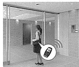
「WAY PLUS」は、集合住宅用スマートドア「R's SDX」「EXIMA80St」に搭載された各住戸のキーを使用して、エントランスの自動ドアや宅配ボックス、エレベーターなどの共用設備にも対応できるシステム。すべてひとつのキーで対応できるため建物全体のセキュリティと利便性が向上することが特長。
