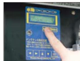
現場でのモニタリングも可能。観測データを液晶に表示、センサの調整なども簡単に行えます。
