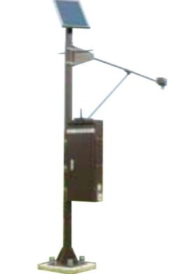
水位・流量観測
