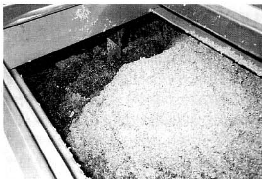
し渣が投入された反応槽
