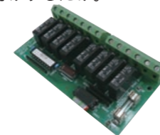
単相リレー基板(注文品) 門番の開・閉動作中信号を出力
