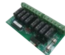
単相リレー基板 門番の開・閉動作中信号を出力
