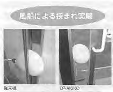
日本自動ドア…次世代型自動ドア「D 2 -AKIKO」、超低騒音で高感度なセーフティターン機能を装備
